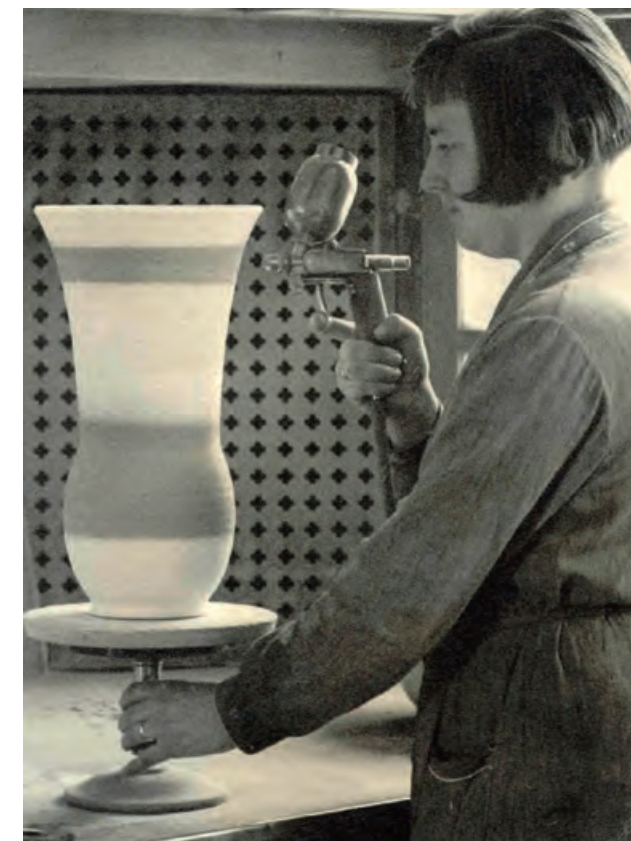
Abb. 1 Arbeiterin der Staatlichen Majolika-Manufaktur in Karlsruhe bei der Arbeit mit einem «Aerographen» um 1930 (Badisches Landesmuseum, Karlsruhe).
