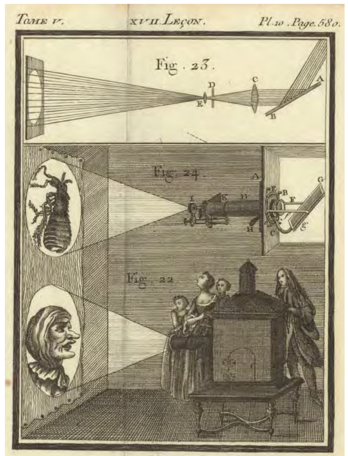
Abb. 6 Auch das Sonnenmikroskop (oben und Mitte) war ein Projektionsapparat, der durch die enorme Vergrösserung ekliger Krabbeltiere Grusel hervorrufen konnte. Bezeichnenderweise bildet es Abbé Nollet in seinem Werk «Leçons de physique expérimentale» von 1755 zusammen mit der Laterna magica ab.
