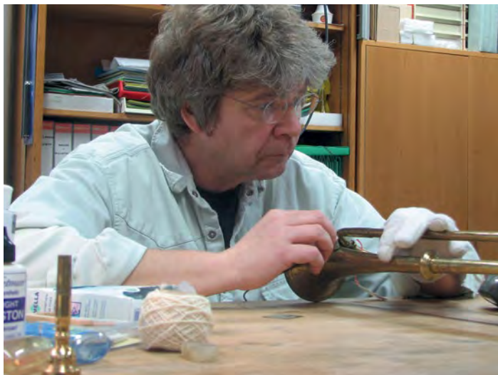
Unterstützung für die Forschung: Andrea Fornaro führt Wandstärkenmessungen an Blechblasinstrumenten der Sammlung Bernoulli durch.
