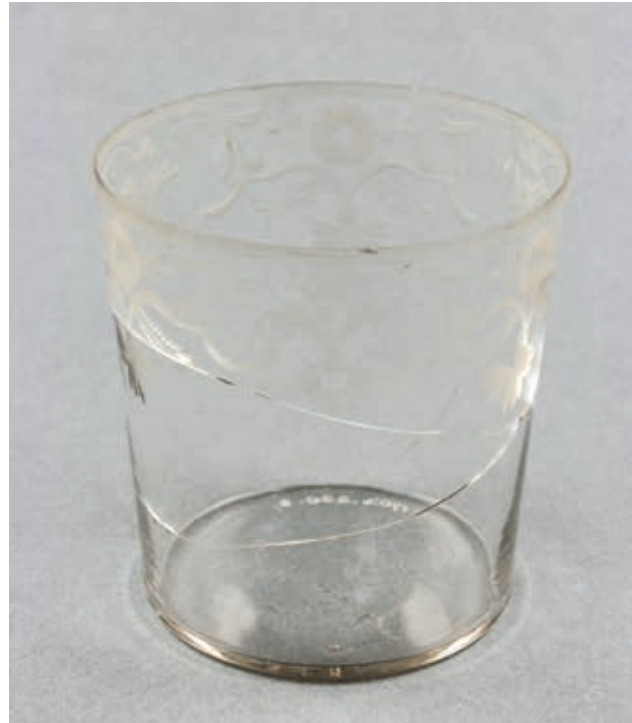
Abb. 4 Feine Risse in einem Trinkglas, die in der Notkonservierung geklebt werden. // Inv. 1902.230.3.
