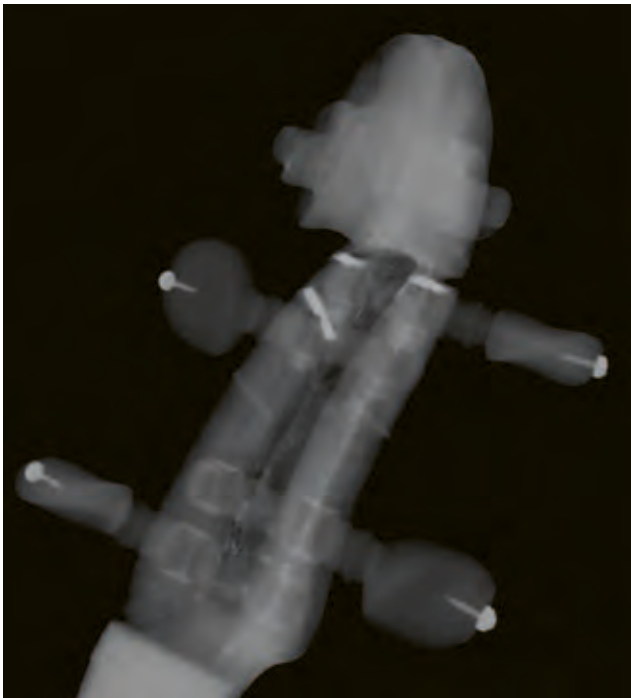
Abb. 3 (oben) Wirbelkasten der Gagliano-Geige mit nahezu unsichtbarer Reparaturstelle // Inv. 2023.201.
