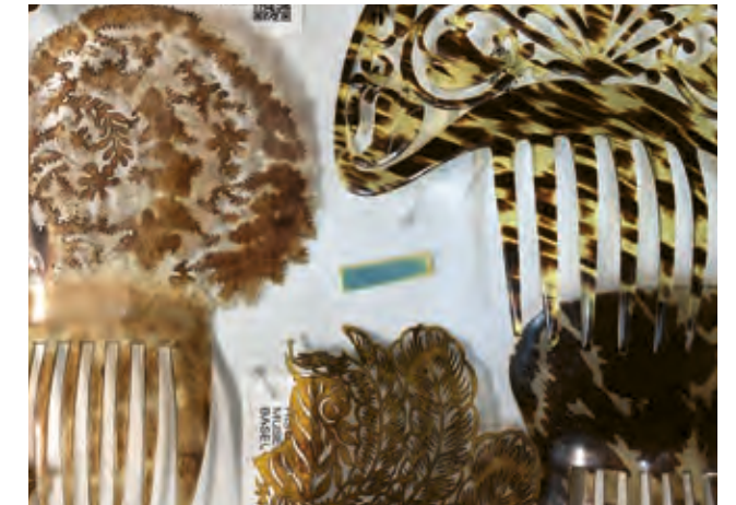
Abb. 11 Der blaue Indikatorstreifen neben dem Haarschmuck aus Celluloseacetat zeigt durch seine Gelbfärbung im Randbereich das Vorhandensein säurehaltiger Ausdünstungen an.
