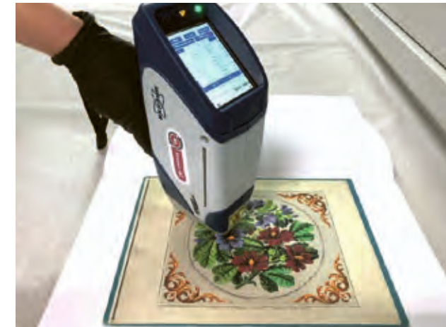
Abb. 9 XRF-Analyse einer Stickvorlage. Die Analyse-Resultate ergaben eine Arsenbelastung aufgrund von Grünpigmenten.
